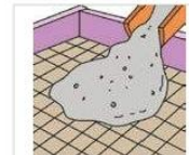
콘크리트를 타설하다 to pour concrete
