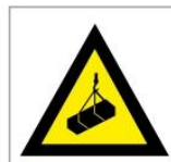
매달린 물체 경고 warning: hanging objects
